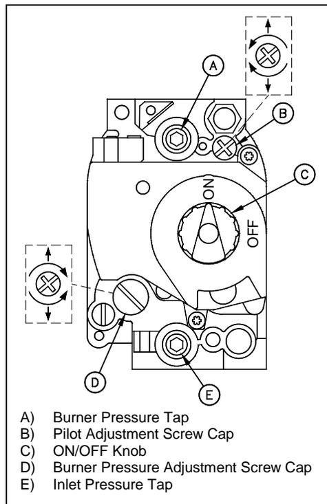
**2.11.4. MAIN BURNER SYSTEM ADJUSTMENT**
