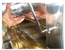
TILT THE RUNNER UP SLOWLY WHILE PULLING THE RUNNER OUTWARD AWAY FROM THE SIDE OF THE CABINET. **DO NOT FORCE IT ASSURE BOTH SIDES** ARE IN THE SAME POSITION AS YOU ARE LIFTING THE RUNNER
