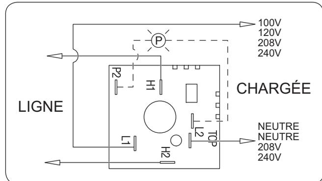
Schéma de câblage du commutateur à progression (vue arrière)
