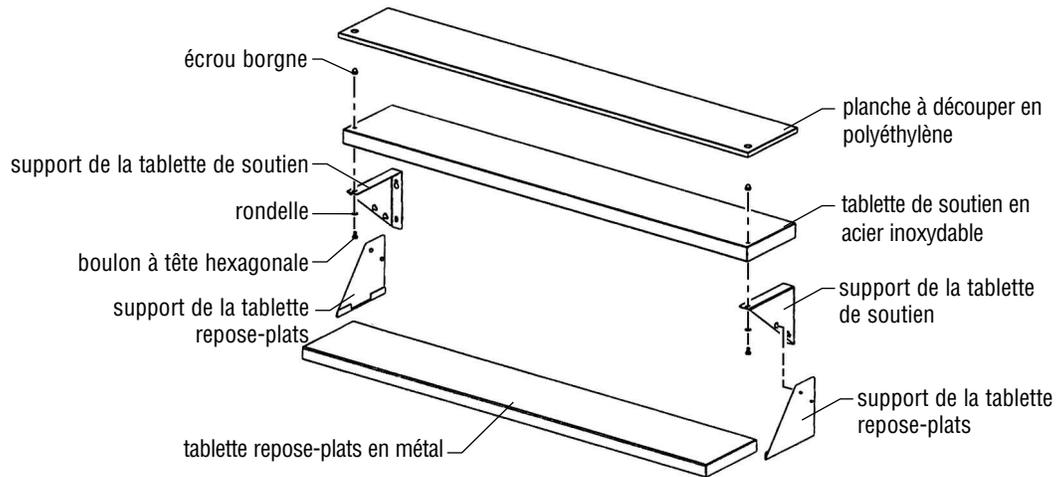
1. Fixez les supports à la tablette de soutien en utilisant les écrous borgnes, les rondelles, les boulons et les trous pré-perçés. Remarque : les écrous borgnes doivent être en haut.
