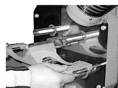
Para los modelos con el componente de alimentación superior, gire suavemente la canasta metálica superior de todo el camino hacia la izquierda y luego tire suavemente hacia arriba.
