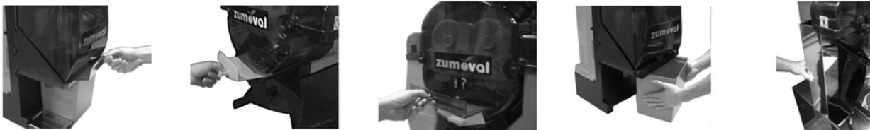
Retire la cubierta frontal, moviéndose lentamente hacia arriba y hacia.
