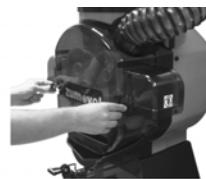
Retirer le capot avant, en dévissant les deux vis latérales.
