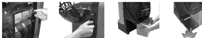
**Minimatic:** Afloje el tornillo y el tornillo del alimentador de cabeza, coloque el tubo de alimentación. Coloque el cubo de la cáscara y el jugo de la bandeja.
