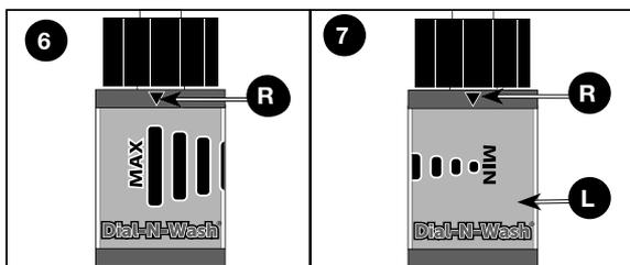
Régalez la pression en faisant tourner le régulateur Dial-N-Wash (L) dans le sens des aiguilles d'une montre pour augmenter la pression ou dans le sens contraire pour diminuer la pression, en alignant la flèche avec la ligne indiquant la pression désirée du régulateur Dial-N-Wash.
