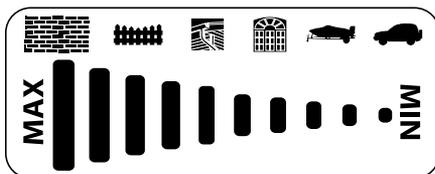
**REMARQUE:** Pour l'application de produits chimiques installez la buse de projection faible noir et faites tourner Dial-N-Wash au réglage de pression « MAX ».
