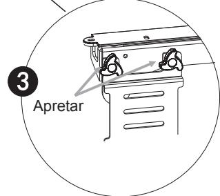
Coloque la placa de unión en el ensamble de control y luego apriete las perillas
