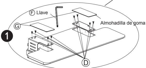
Conecte y fije la placa de unión y la bandeja del teclado con los 8 tornillos utilizando la llave F para apretar. Almohadilla de goma en cada lado para evitar que se raye.
