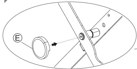
Cubierta decorativa del sujetador para la conexión del brazo
